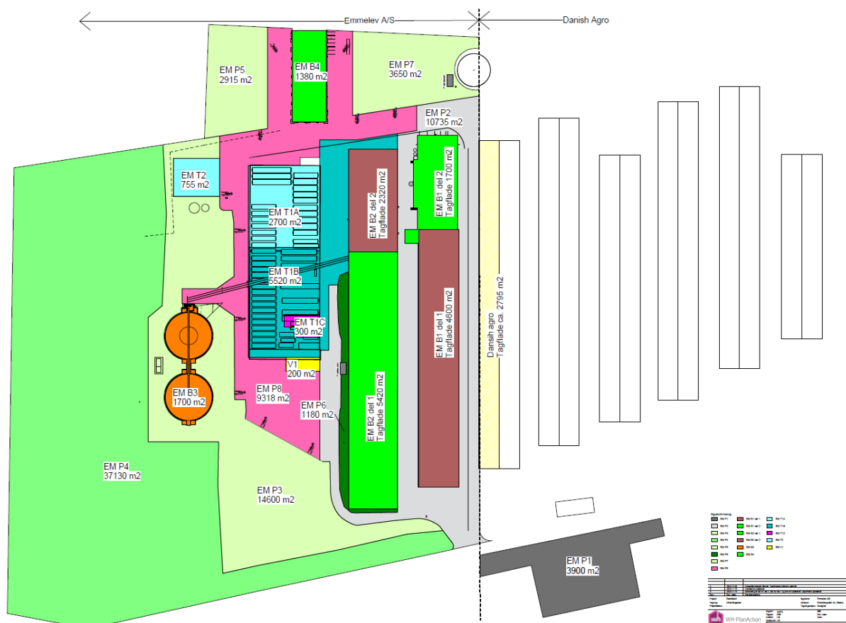
Figur 1: Situationsplan med markering af de forskellige opsamlingsområder for tag- og overfladevand (se også bilag for sørre udgave)
