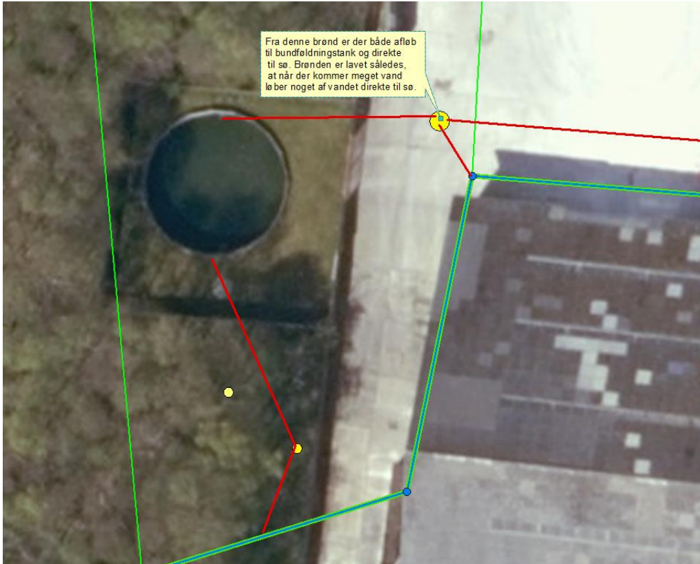
Figur 9. Afløb både til bundfældningstank og til sø.
