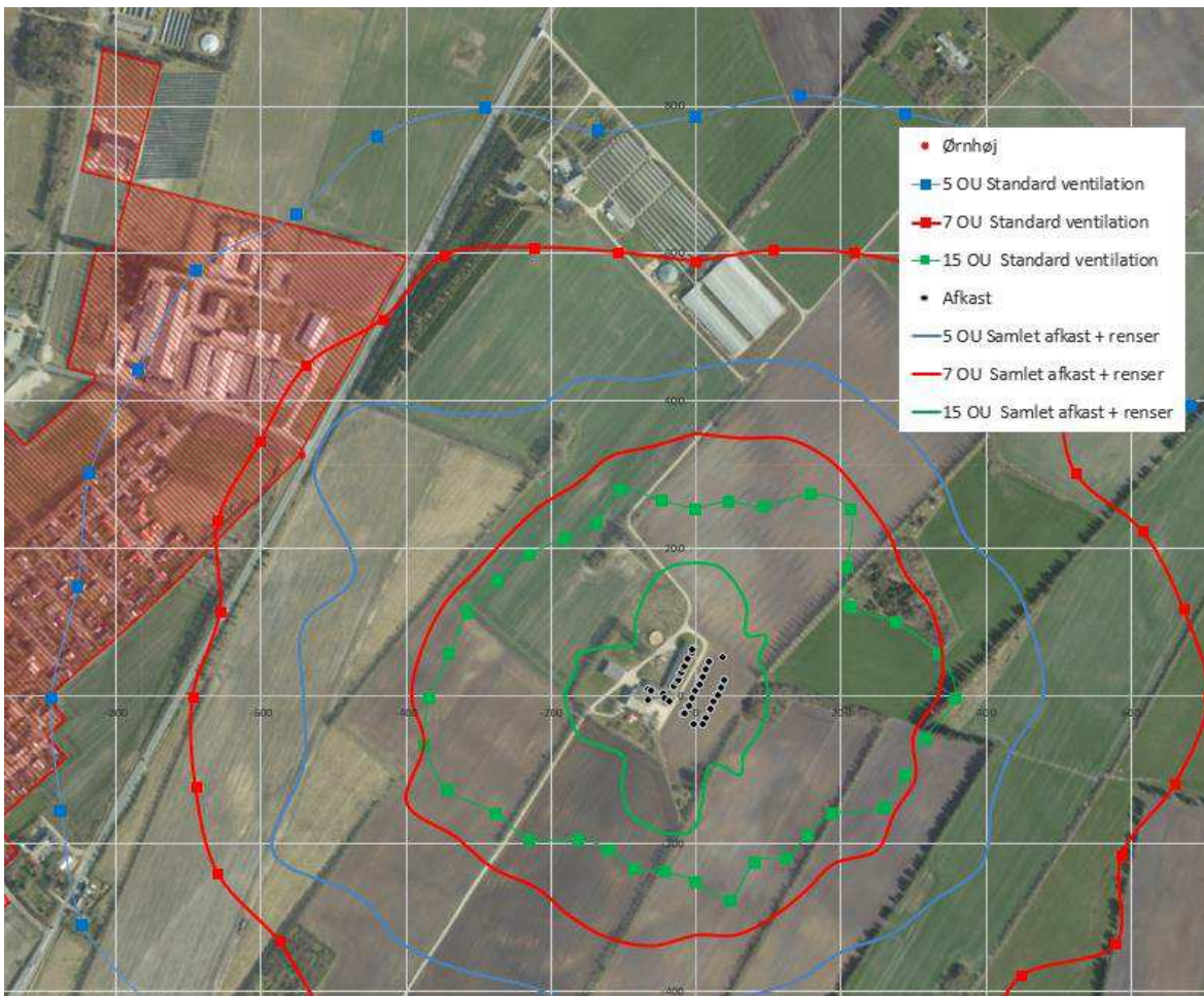
Figur 5. Grafisk visualisering af isokurver for lugtgene fra produktionen Trehøjevej 80 med hhv. ansøgt ventilationsdesign og et standardventilationsdesign. Figuren viser Isokurverne baseret på afkast som er 6,4 meter = samme som KIP.
