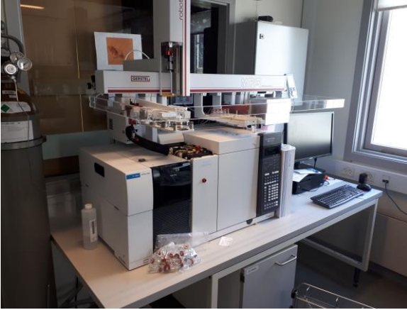
Gerstel MPS: analyseapparat til bl.a. miljøfremmede stoffer, herunder PAH.
