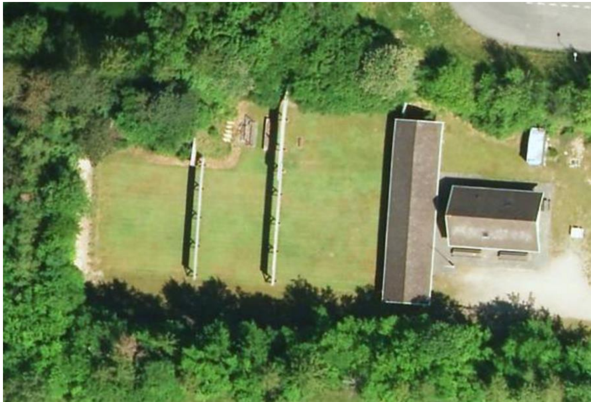
Figur 2: Luftfoto af skydebaneanlægget med skydehus og blænder. Huset bagved selve skydehuset er klubhuset. Volde og skrænter fremgår ikke tydeligt på grund af bevoksning.
