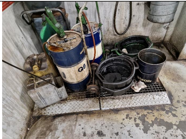
Foto 2. Opbevaring af nye produkter indendørs på spildbakke. Ok.
