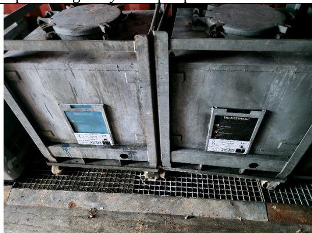
Foto 5. Farligt affald (bremse- og bremsevæske) på spildbakke.
