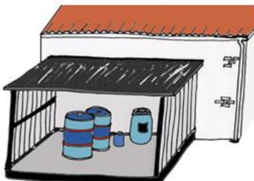
Figur 2 Udendørs opbevaring under tag med tæt bund og opkant.
