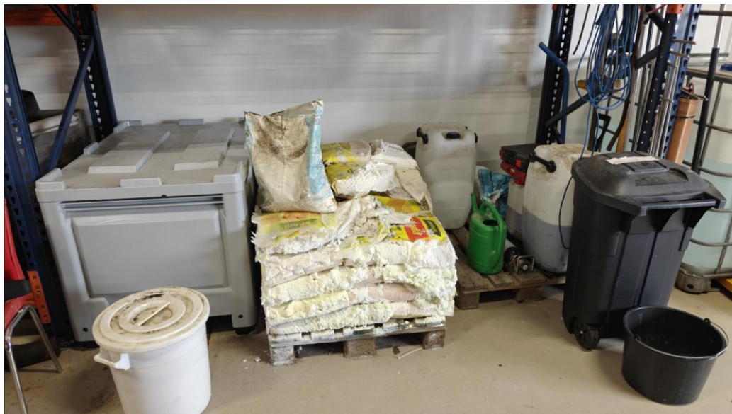
Til højre beholdere med kølervæsker – Til venstre dobbeltvægget beholder som kan benyttes til opbevaring af farligt affald.
