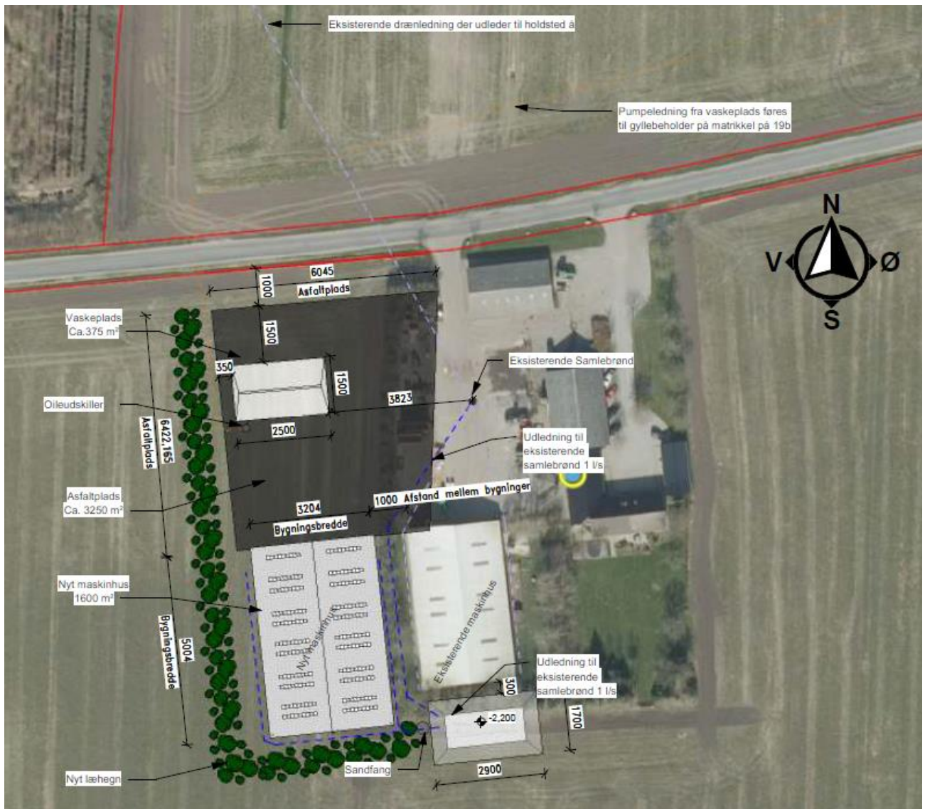
Figur 1: Placering af affaldsforbrændingsslagge. Der lægges slagge ud under det mørke areal med den overdækkede vaskeplads samt under maskinhuset mod sydvest.
