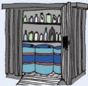
Figur 2: Udendørs opbevaring i container med dobbelt bund.
