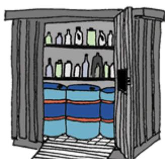
Figur 3 Udendørs opbevaring i container med dobbelt bund.
