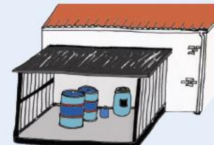
Figur 3: Udendørs opbevaring under tag med tæt bund og opkant.
