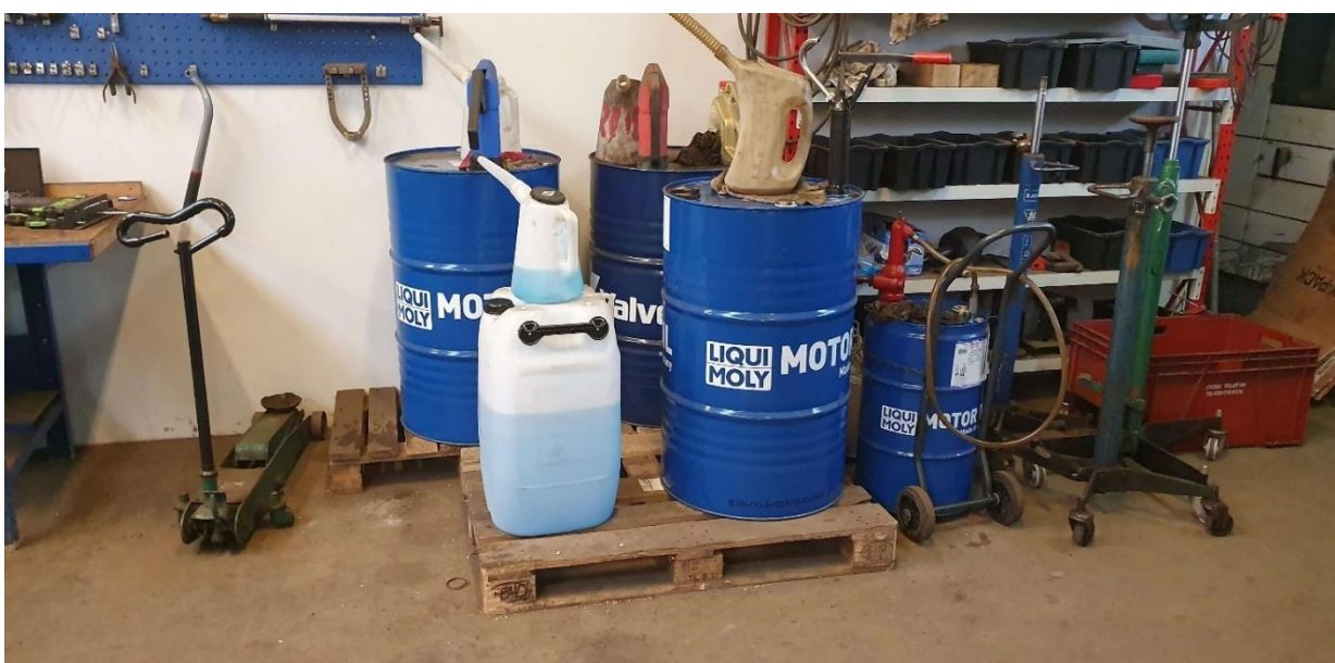
Motorolie m.m. opbevares bagest i værkstedet uden risiko for at det kan løbe i kloak eller ud på jord.
