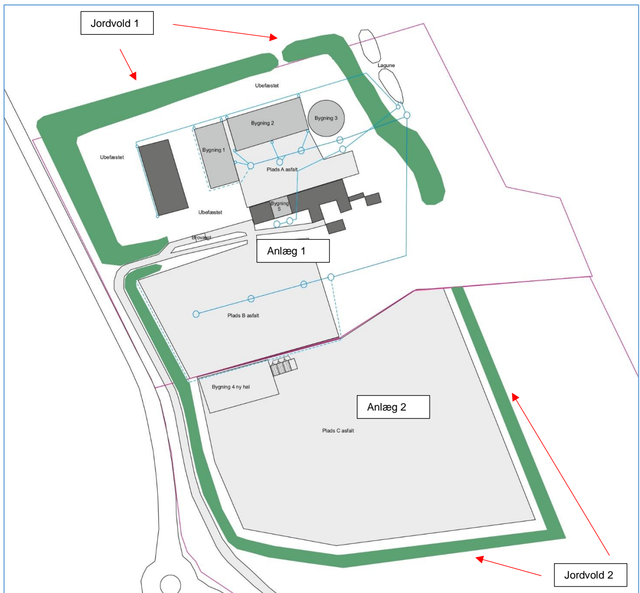
Foto 2 - CAD tegning over området, inkl. eksisterende Anlæg 1, udvidelsen (Anlæg 2) og de to jordvolde
