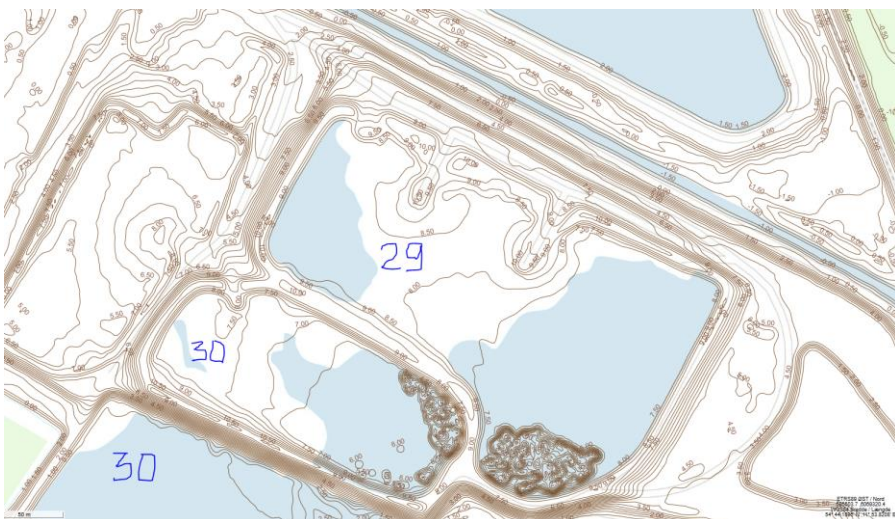
Figur 3. GIS-kort med højdekurver fra juli 2024. I deponeringsenhed 29 ses højder op til kote + 10 m. Toppen af digerne midt i deponeringsenhed 30 er på det højeste sted i kote + 11 m. NS NYK oplyste, at der er givet tilladelse til at øge deponeringshøjden fra kote 4,5 til kote 8,5 m i kommunens landzonetilladelse fra 2015.
