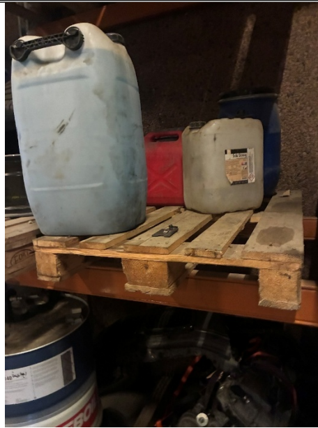
4. Kemikalier opbevarede forkert uden spildebakke
