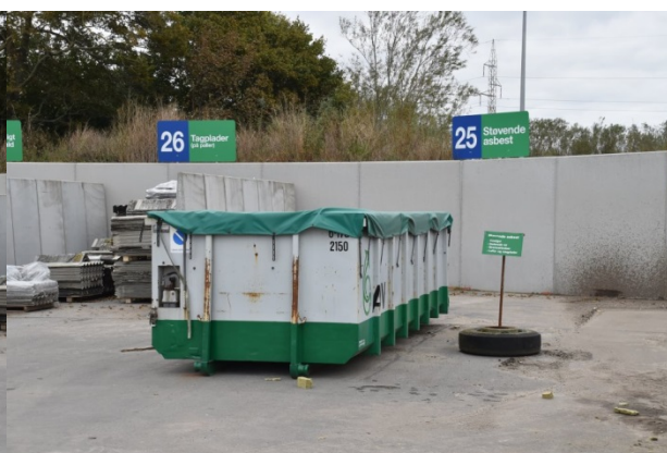
Asbestholdigt til deponering i særskilt celle på Trynbakke deponeringsanlæg
