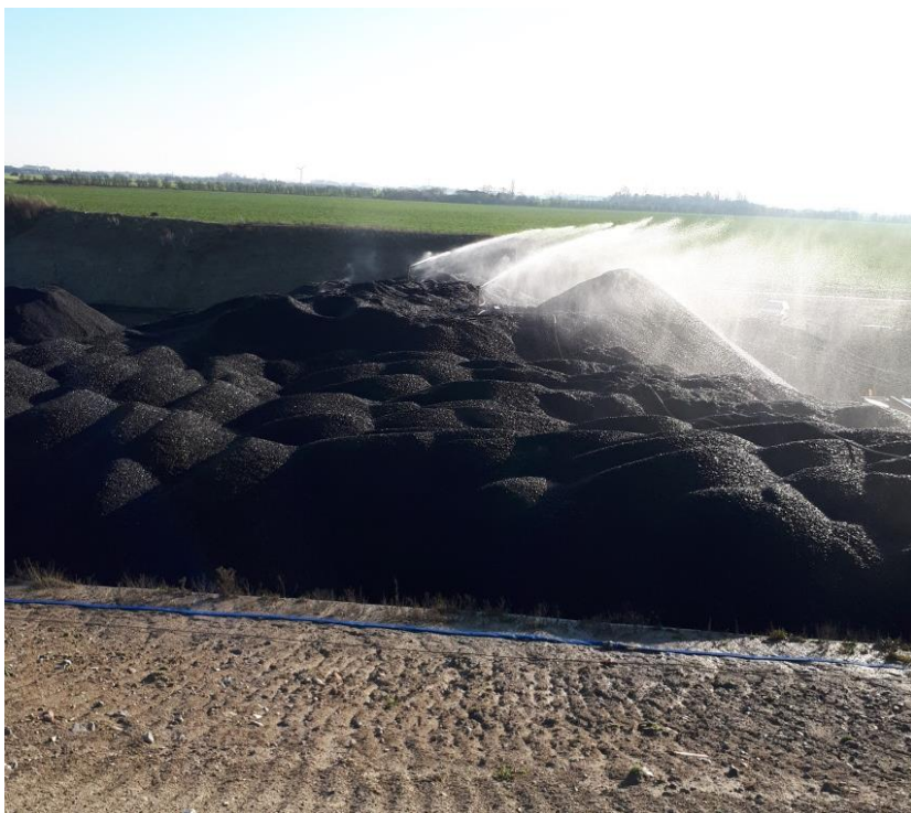
Foto 4. Slukningsarbejde med sprinkler ved kuloplag
