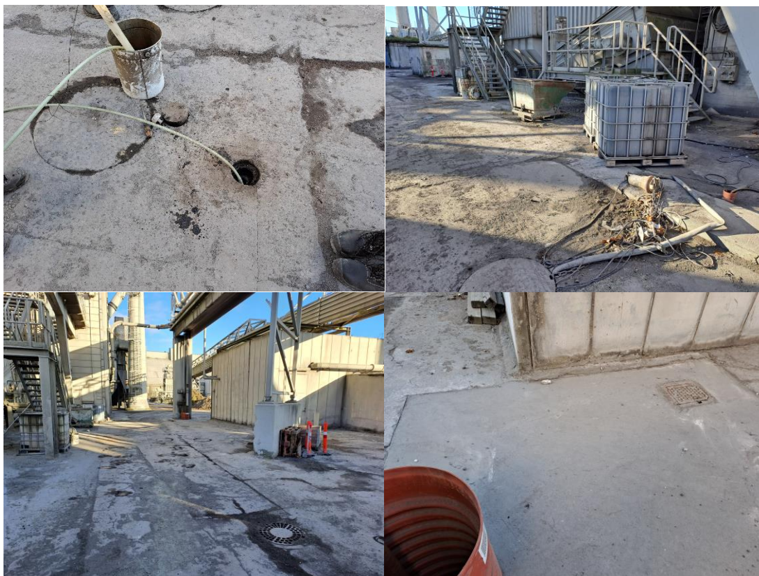
Figur 7: Forurenede arealer ved ovn 87, samt opsugning af vand og palletank uden spildbakke
