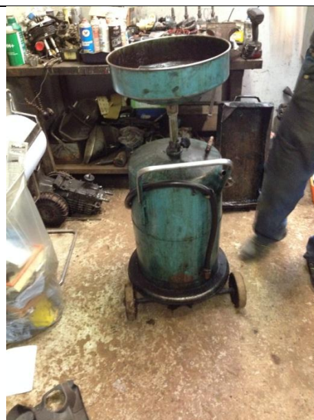
Foto 6 Beholder til opsamling af olier mv.
