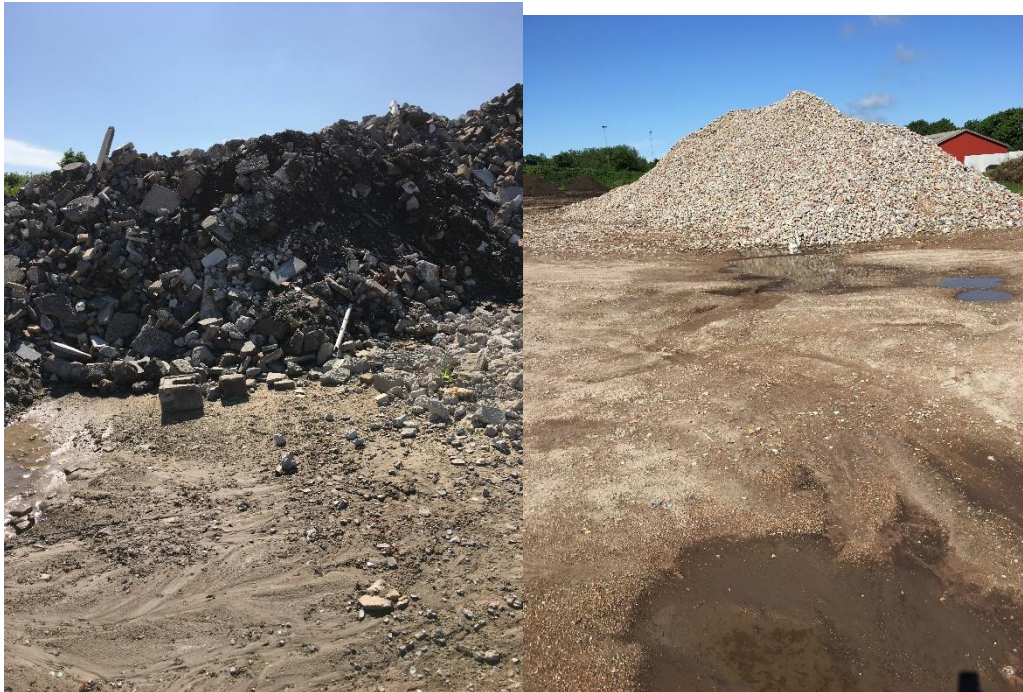
Figur 2 Tv. Oplag af beton. Th. knust beton.
