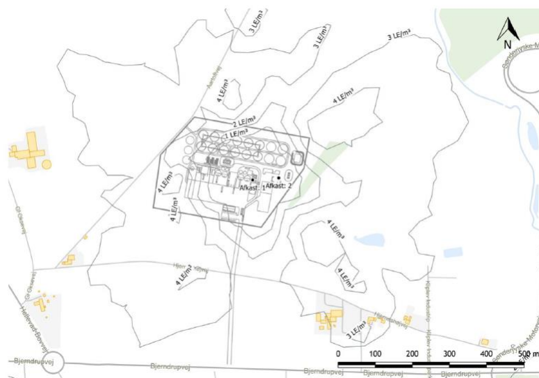
Figur 3: Lugtodbredelse i området omkring biogasanlægget.
