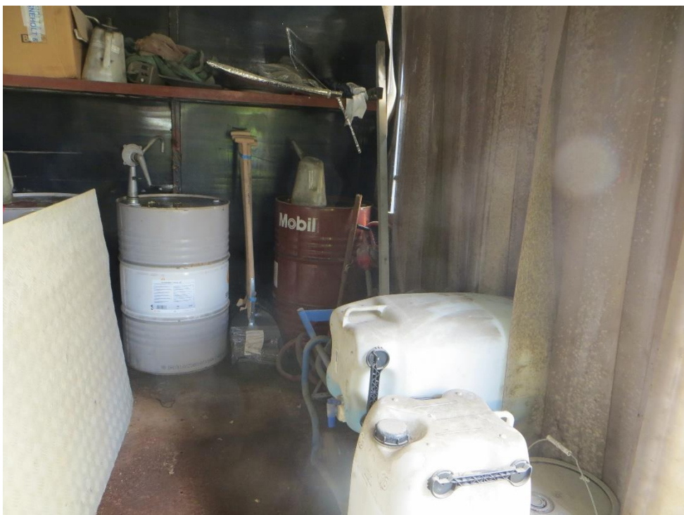
Container med oplag af flydende olie og kemikalieaffald uden spildbakke.
