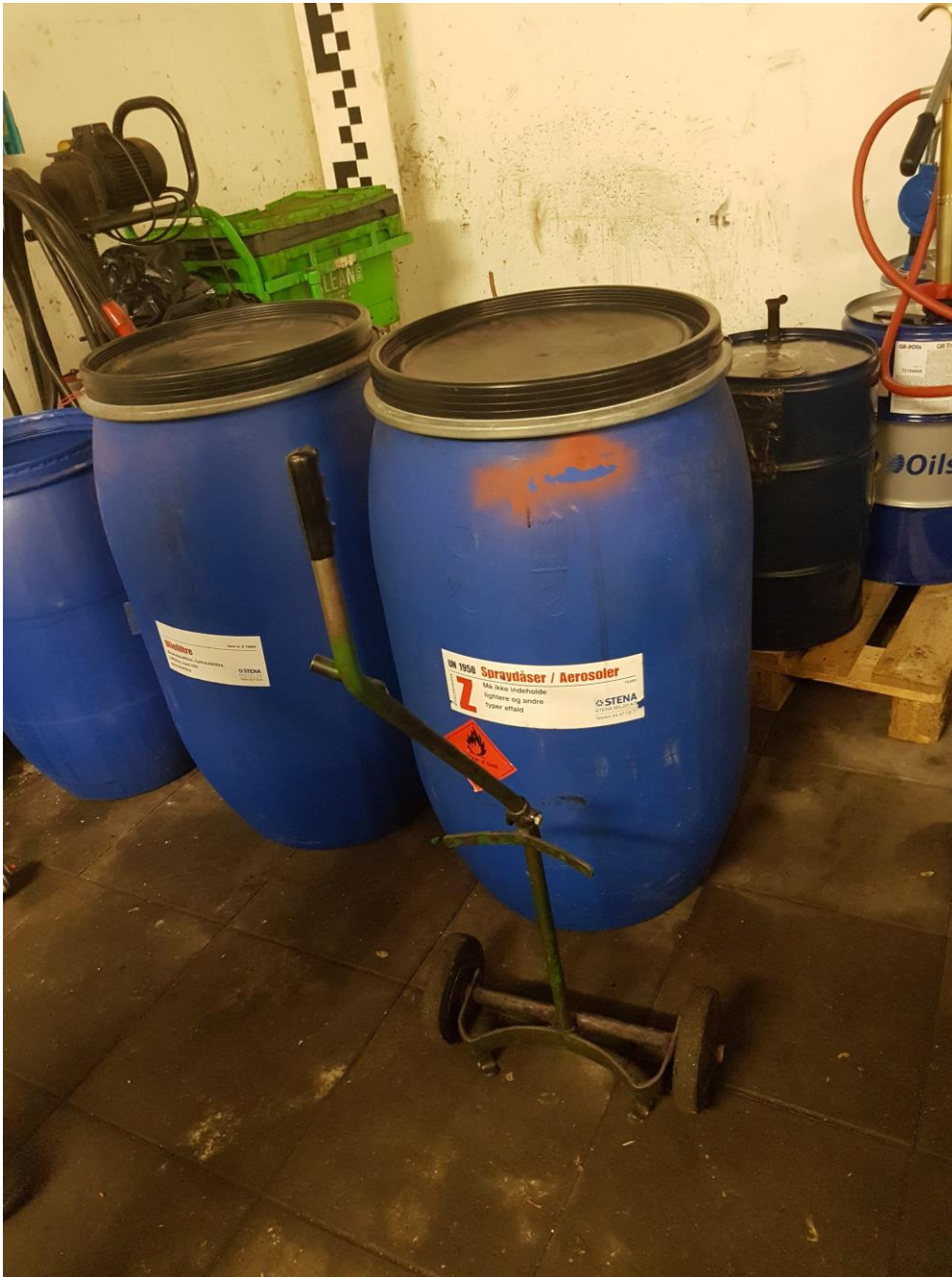
Figur 3 Opbevaring af farligt affald på fliser. Der er tegn på spild.
