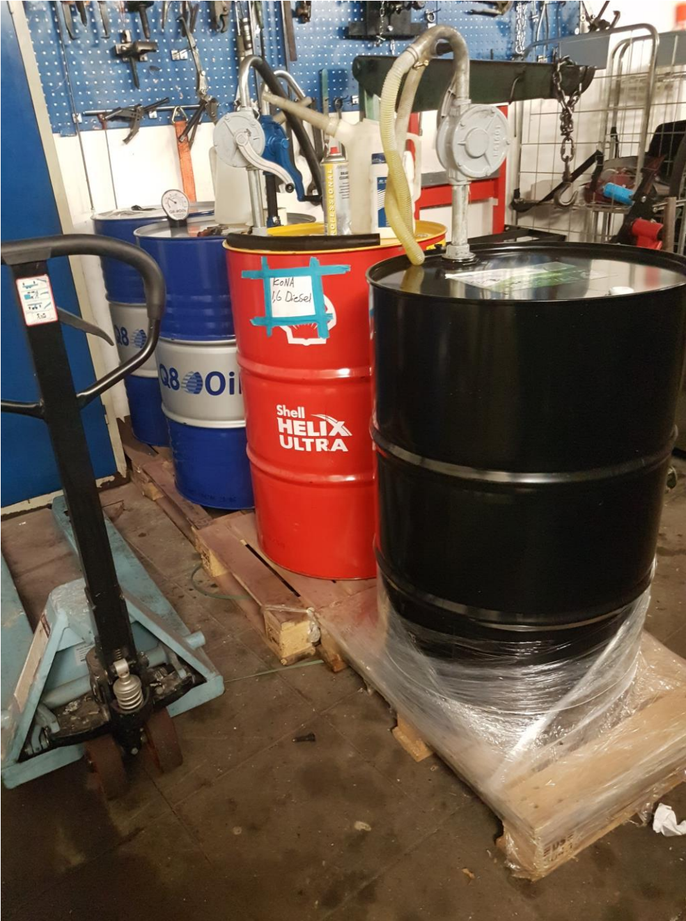
Figur 4 Opbevaring af råvare på fliser. Der er tegn på spild.
