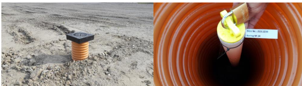
Foto 2: Monitoringsboring M14 med beskyttelsesrør og køredæksel til venstre og med lås og mærkning til højre.
