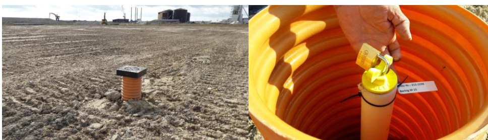
Foto 4: Moniteringsboring M15 med beskyttelsesrør og køredæksel til venstre og med lås og mærkning til højre.
