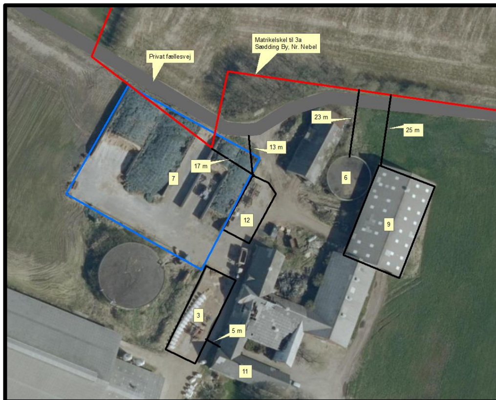
Figur 1. Manglende overholdelse af afstandskrav.
