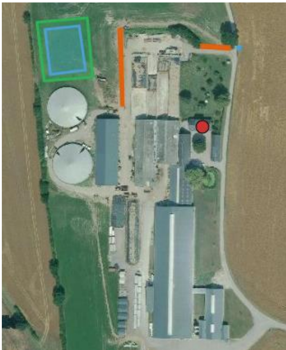
Figur 2. Oversigtskort over placering af bassin (blå angiver bassin og grøn jordvold) (jf. også bilag 1) samt etablering af jordvolde (orange streger) på Nis Thuesensvej 15 (rød).
