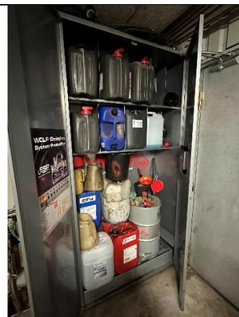
Billede nr. 12: Opbevaringsskab med opsamlingsbakke. (2023)
