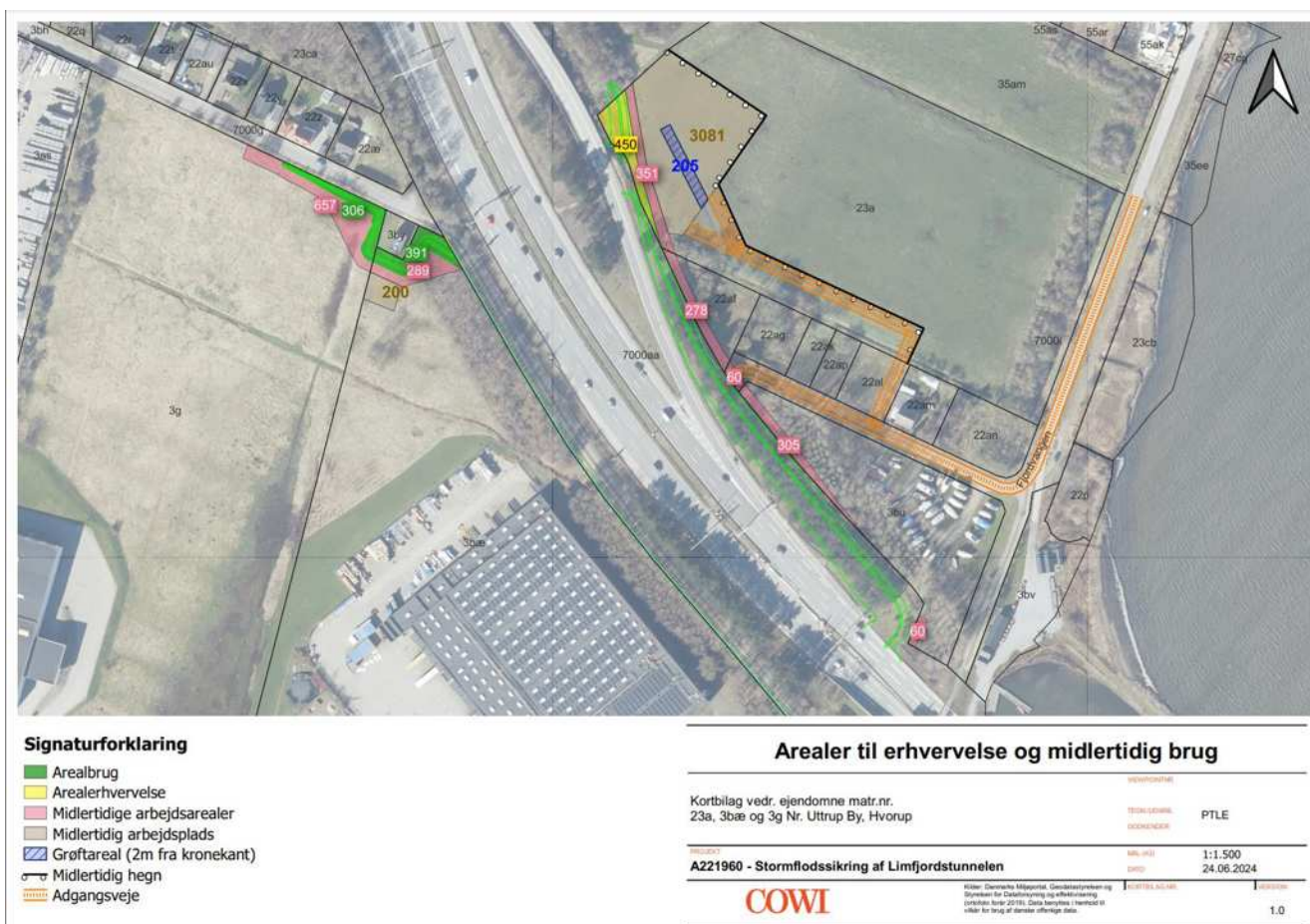
Figur: Oplagspladsen vises med brunlig markering og er på 3081 m 2 . Inden for den gule markering er den permanente inddragelse på 200 m 2 engareal. Blå markering viser grøften, hvor dele skal lukkes.
