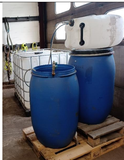
Foto 19: Opstilling af forsøg med tømning af trykbeholdere.
