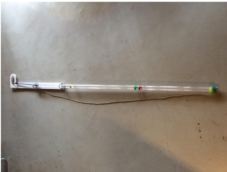
20. Pejlerør til olieudskiller.
