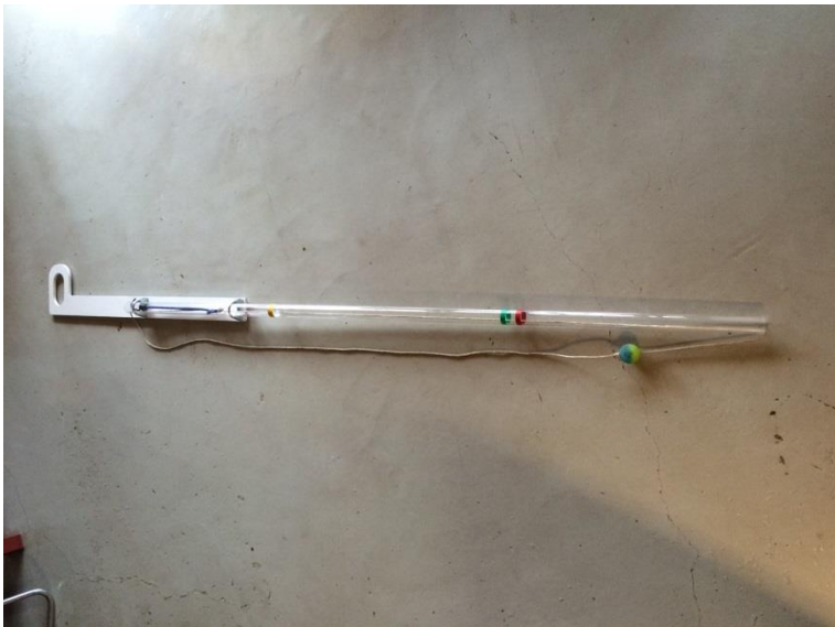
21. Pejlerør til olieudskiller.
