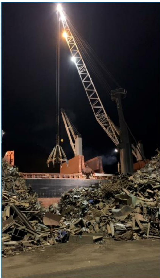
Figur 6: Lastning af skrot med kran 15.
