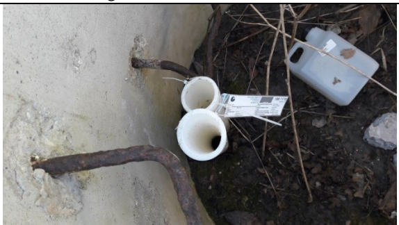
Billede 28. B4 – uden prop og lås. Der er den 4. april 2018 fremsendt foto af afproppede rør men ingen lås.
