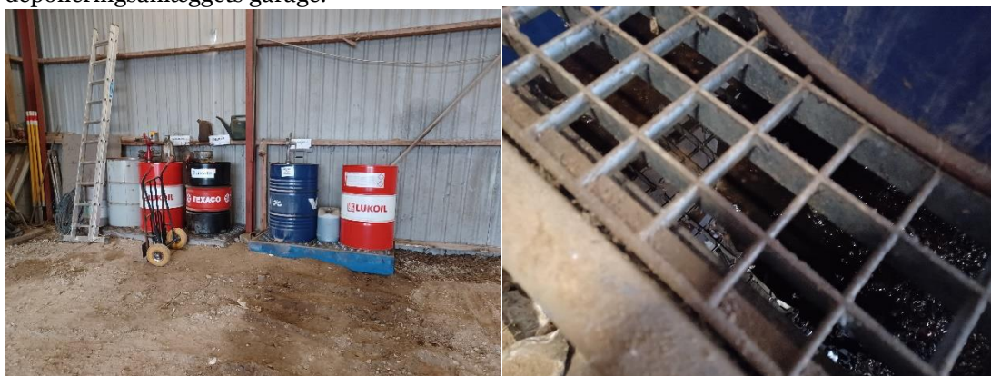
Figur 5: Oletønder lokaliseret i garage tilhørende deponeringsaktiviteter opstillet på spildbakker (tv) og olie i spildbakker (th)
