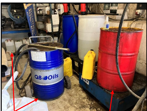
Beholdere, der skal flyttes til oplagsplads, og olie m.v. på opsamlingskar
