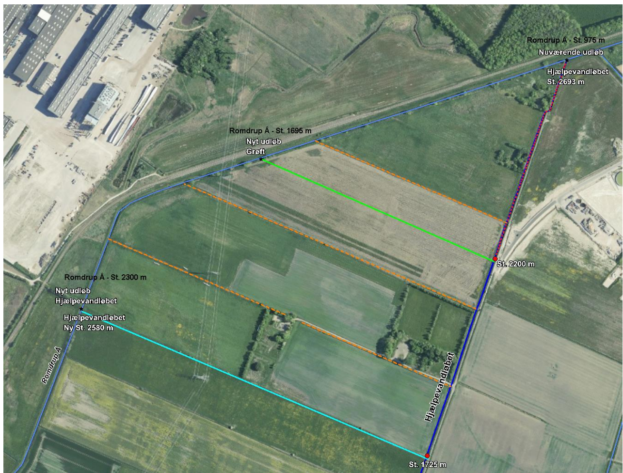
Figur 2: De projekterede tiltag vedrørende vandløb. Den lyseblå streg viser Hjælpevandløbets nye forløb med udløb i Romdrup Å. Den lysegrønne streg viser den nye afvandingsgrøft. De orange stiplede linjer viser nuværende grøfter som sløjfes, og den røde stiplede linje (påført af myndigheden) viser den del af det nuværende forløb af Hjælpevandløbet, som skal fyldes op. Røde cirkler viser, hvor det nuværende forløb afskæres ved opfyldning og ledes mod vest i de nye forløb.
