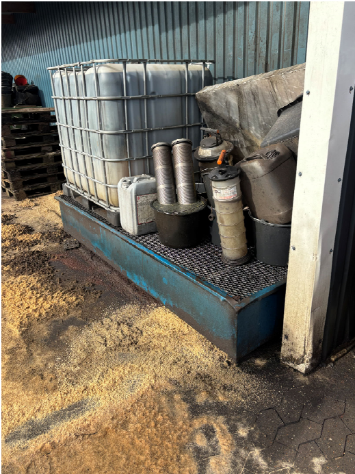
Figur 1. Spildbakke er ikke afskærmet mod vind og vejr. Tydelige tegn på spild af olie på belægningen.
