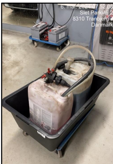
Spildsikring etableret efter tilsyn
